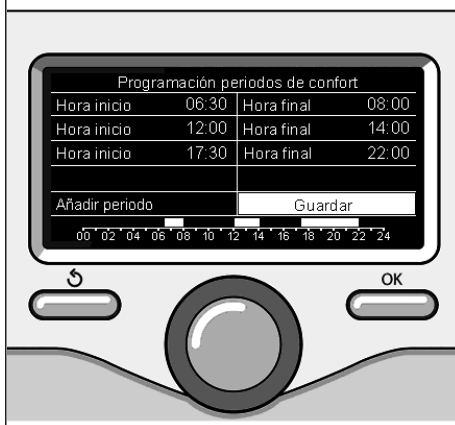
Programar períodos confort programación horaria calefacción
